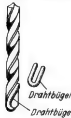
Durch Einlegen eines Drahtbügels in die Nuten an der Bruchstelle des Spiralbohrers läßt sich der Bohrer wieder einspannen
